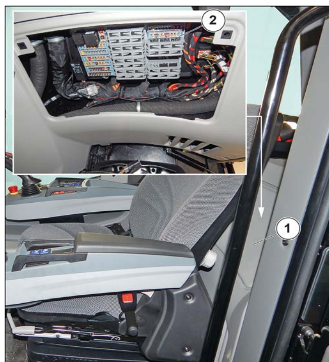
Afbeelding 214: Zekeringen en relais in cabine
